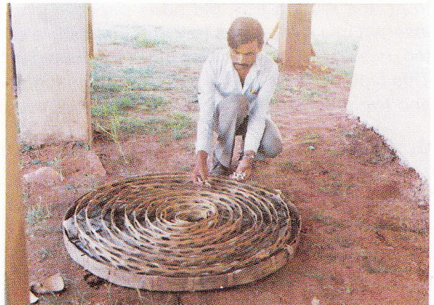
Fig. 7. Bamboo spiral moutage
